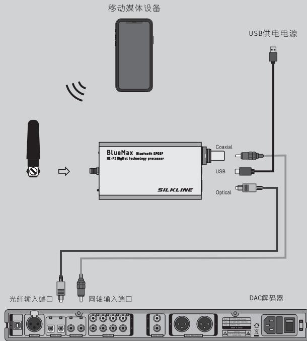
请确保旋紧蓝牙天线,如接触不良会导致蓝牙信号不能连接、传输距离过短或声音断续等现象。
