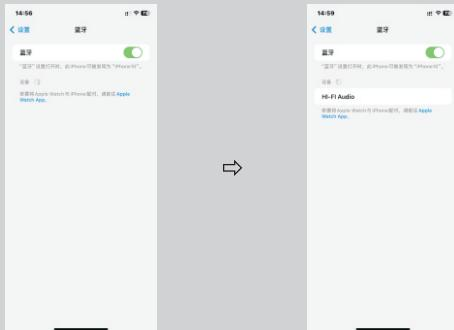
② 在搜索到本机器的广播名称后，用户点击设备名称即可自动完成连接(指示灯长亮显示)。连接成功后，机器下次开机直接连接该移动设备，而不再进入连接广播模式。
